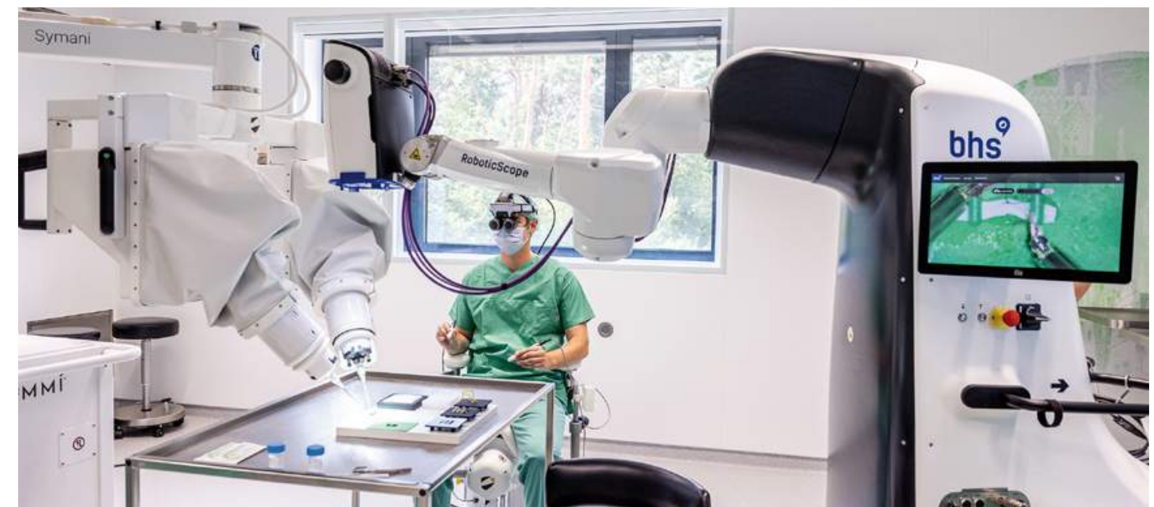
Prof. Dr. Maximilian Kückelhaus präsentiert bei einem „Trockentraining“ das neue Verfahren. Der Operationsroboter (links) ist mit einem robotischen Mikroskop (rechts) vernetzt.
