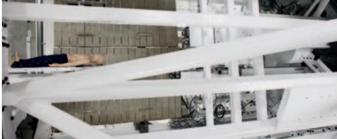
Das Besondere am WPE: Die Kombination aus drei um die eigene Achse schwenkbaren Bestrahlungsgeräten, auch Gantries genannt, und einem Fixed-Beam-Raum mit der weltweit innovativsten Scanning-Technologie. Die Installation der Gantries ist bereits beendet. Auch der ufoförmige Protonenbeschleuniger – das Herzstück des Zentrums – ist eingebaut. Genauso wie das Strahlführungssystem, die so genannte Beamline.
